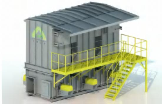
蓄热式氧化炉设备简称RTO，全称（Regenerative Thermal Oxidizer），基本原理是在高温条件下（ $\geq 760^{\circ}\text{C}$ ）将有机废气（VOCs）氧化生成 $\text{CO}_2+\text{H}_2\text{O}$ ，净化效率高达99%。氧化产生的高温气体流经特制的陶瓷蓄热体，使陶瓷体升温而“蓄热”，下个过程是废气从已经“蓄热”的陶瓷经过，将陶瓷的热量传递给废气，有机废气通过陶瓷作为换热器载体，反复进行热交换，从而节省废气升温的燃料消耗，降低运行成本，热回收效率高达95%。在中高浓度的条件下，RTO可以对外输出余热，通过蒸汽、热风、热水等形式加以利用，在满足环保目标的同时，实现经济效益。
